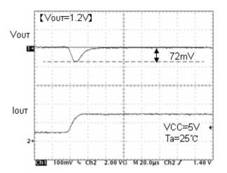
Fig. 17 Transient Response Io=1→3A(10µs)
